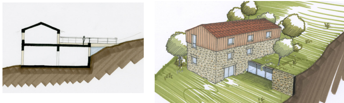
Exemple de volume secondaire en jonction avec le terrain naturel
